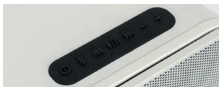
Cały panel sterujący jest wodoodporny, przyciski przykryto gumową uszczelką.
