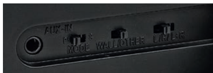
Control X Wireless mogą pracować w różnych konfiguracjach, minihebelkami ustalamy sygnał L, P lub mono (L+P), jest także regulacja poziomu niskich tonów.
