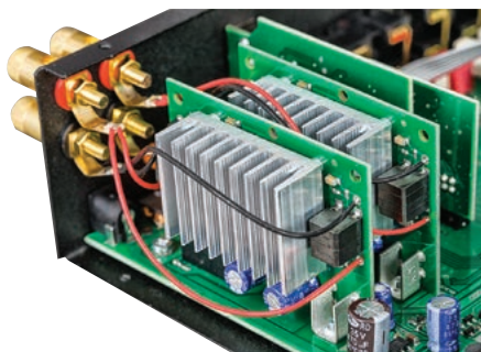
Impulsowe moduły końcówek mocy zajmują niewiele miejsca, ale i dają niewysoką moc...
