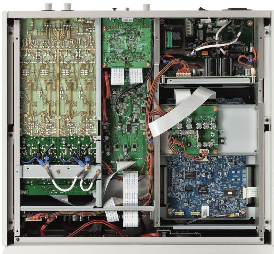
Po odkręceniu dolnej ścianki pojawia się dostęp do elektroniki sterującej i sekcji cyfrowej.
