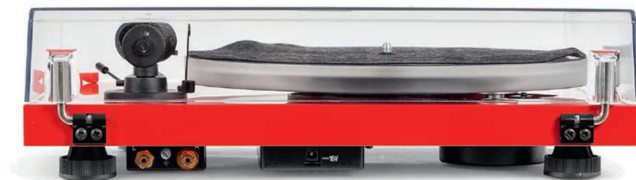
Umieszczenie modułów z gniazdami pod plintą nie ułatwia podłączenia gramofonu, pozwala jednak zamaskować wtyczki.
