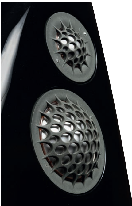
Tandem aluminiowych kopulek – dwucalowa średnionowa D50 i jednocalowa wysokotonowa D26 – jest wspólną cechą prawie wszystkich kolumn Vivid Audio, a wywodzi się z czterodrożnych Nautilusów. Podobnie jak tam, mają one długie komory wytłumiające, a dzięki specjalnym zabiegom w obrębie samych membran (wyprofilowanie i wytłumienie), rezonanse „break-up” zostają przesunięte daleko powyżej wyznaczonych im zakresów pracy.
