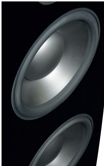
18-cm niskotonowy C125 jest naturalnym partnerem dla kopułki D50 – łączy się z nią przy dość wysokiej częstotliwości podziału (900 Hz). Tak wysoko pracuje jednak tylko jedna 18-ka (ta położona najbliżej D50), pozostałe trzy są filtrowane niżej, aby nie „wtrącać się” w przetwarzanie średnich tonów, których źródła nie powinny być od siebie odsunięte. Na zdjęciu dwie 18-ki, a dwie kolejne zainstalowano z tyłu – dokładnie naprzeciwko.
