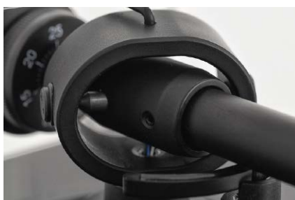
Konstrukcję i montaż rurki w tulejce (zawieszenia) wykorzystano do przygotowania regulacji azymutu, którą można przeprowadzić luzując umieszczoną z boku, małą śrubkę.
