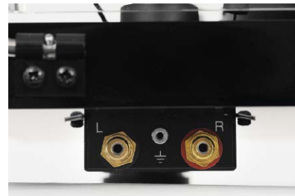
Sygnał wyprowadzamy parą bardzo porządnymi RCA, chociaż dostęp do nich nie jest zbyt wygodny.
