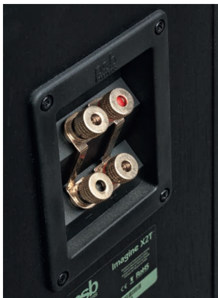
Gniazdo przyłączeniowe jest tutaj podwójne, w standardowej „puszce”; nie ma czego podziwiać, nie ma się czego czepiać.
