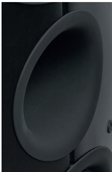
Z oddzielnych komór dwóch głośników niskotonowych wyprowadzono, na przedniej ściance, tunele bas-refleks o znacznej średnicy (7 cm), jednak dzięki ich dużej długości (22 cm), ustalono niską częstotliwość rezonansową (ok. 30 Hz).
