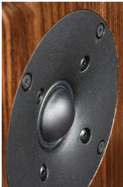
29-mm jedwabna kopułka wygląda bardzo tradycyjnie, ale nawet kopułka kopułce nierówna – jej jakość zależy od ułożenia włókien i sposobu nasączenia. Front jest aluminiowym odlewem.
