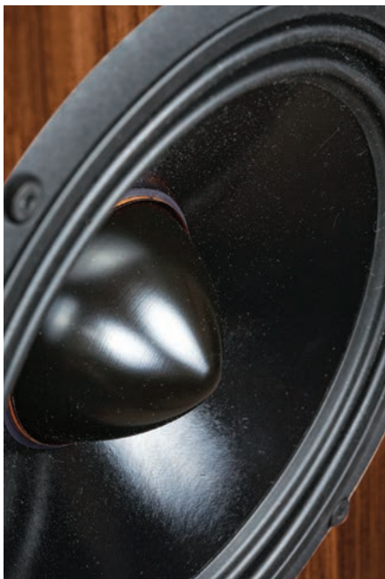
Wierzchołek potężnego korektora fazy sięga płaszczyny przedniej ścianki. Membrana jest wykonana z prasowanej i powlekaniej (z jednej strony) celulozy, gumowe zawieszenie składa się z dwóch fałd.
