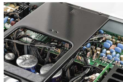
Sekcję przedwzmacniacza rozłożono na kilku płytkach w tylnej części obudowy.
