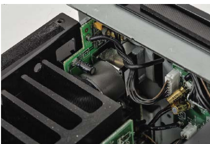
Regulacja głośności – znowu bardzo klasycznie – z potencjometrem Alpsa.
