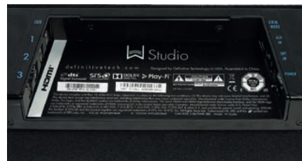
W Studio ma trzy wejścia HDMI i jedno wyjście tego typu, wszystkie kable podłączamy w niecce, z tyłu obudowy.
