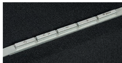
Przyciski na górnej krawędzi obsługują podstawowe funkcje, pozwalają również włączyć urządzenie do sieci Wi-Fi.
