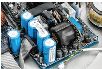
Ten niewielki moduł jest dwukanałową, kompletną końcówką mocy; do chłodzenia wykorzystano fragment górnej ścianki.
