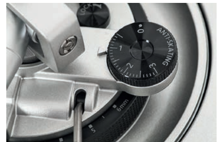
Regulacja anti-skatingu za pomocą pokrętła jest wygodna i precyzyjna.
