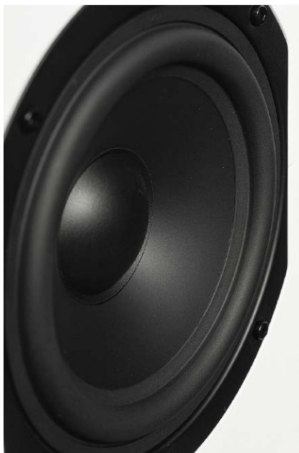
Głośniki nisko-średniotonowe tworzą układ dwupółdrożny, podobnie jak w pasywnych Six 6, gdzie jednak pracują w większej, bardziej „komfortowej” objętości.
