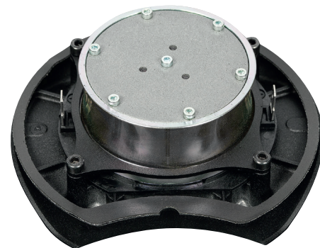
Esotar3 ma jeszcze mocniejszy (niż Esotar2) neodymowy układ magnetyczny, wysoka efektywność jest sposobem obniżenia temperatury cewki przy określonym poziomie ciśnienia, co pozwoliło wyeliminować chłodzenie ferrofluidem.
