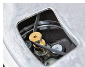
Klasyczny napęd paskowy – silnik przekazuje obroty na wewnętrzną część talerza.
