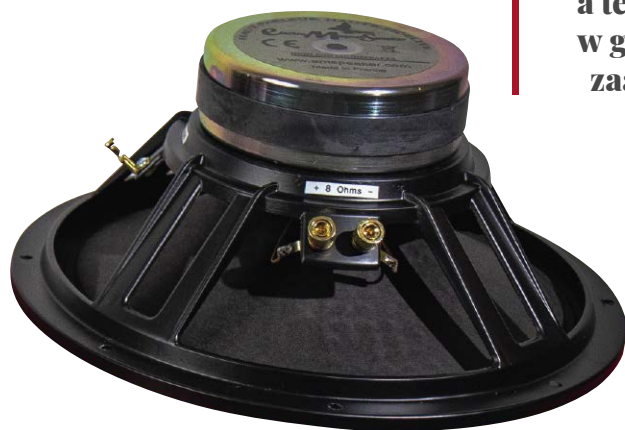
LB12 mkII wygląda od tyłu jak typowy, wysokiej jakości głośnik niskotonowy; jego magnes nie wygląda na bardzo potężny, ale w tym przypadku wystarczy, aby wytworzyć BI ponad 20 Tm.
