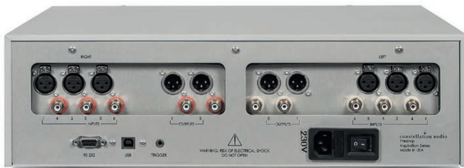
Tylny panel odzwierciedla konstrukcję dual mono, bloki poszczególnych kanałów oddzielono nawet od tylnego panelu, umieszczając jako moduły w dwóch „oknach”.
