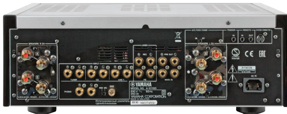
Tylny panel zagospodarowano dużą liczbą gniazd, trzymano się jednak analogowego charakteru konstrukcji.
