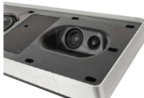
Każdy z kanałów przednich obsługuje układ dwudrożny, ustawiony pod kątem 45 stopni, aby optymalnie działać w każdym z ustawień i obsłużyć kanały sufitowe systemu Dolby Atmos.
