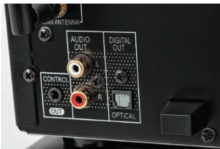
Odtwarzacz – podobnie jak wzmacniacz – ma zarówno gniazda analogowe, jak i cyfrowe; mamy więc dwie opcje połączenia komponentów systemu.
