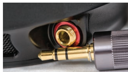
W każdej muszli znajduje się 3,5-mm gniazdo, producent wzbogacił złącze o zakręcany mechanizm.
