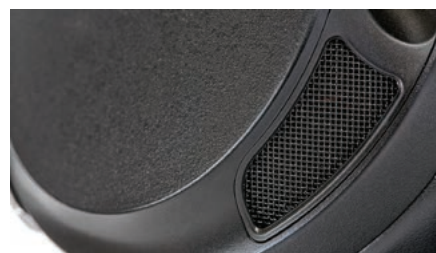
Na obudowie muszli znajdują się otwory połączone z wewnętrzną komorą – konstrukcja nie jest więc dokładnie typu zamkniętego, chociaż tak jest przez producenta klasyfikowana.
