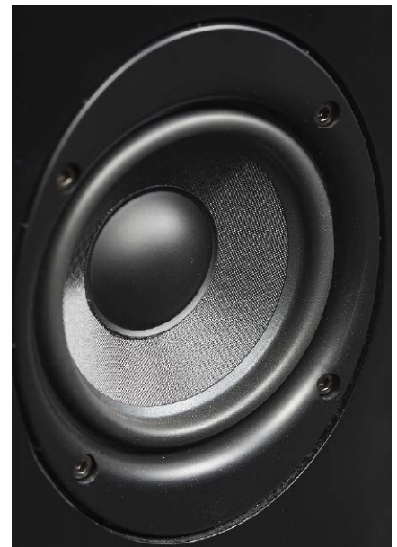
W przetwornikach niskotonowych (na zdjęciu) nakładka jest większa i lepiej usztywnia membranę; w nisko-średniotonowych – lżejsza i bardziej wysmukła, optymalizowana dla zakresu średniotonowego.
