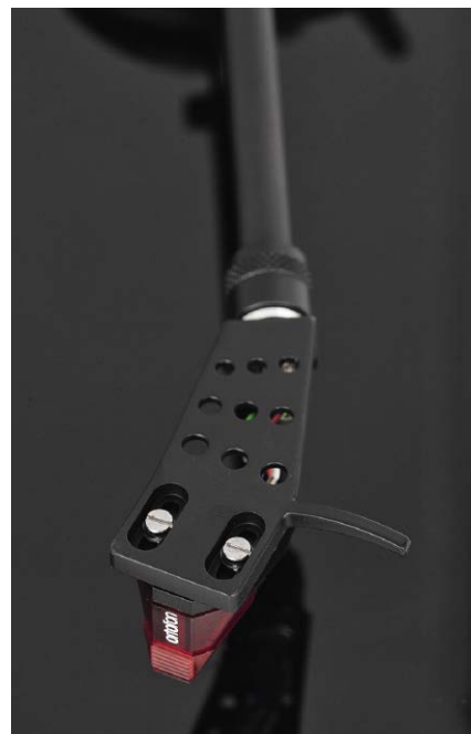
Ramię składa się z prostej rurki z gniazdem, w które wkręcamy kątową główkę.
