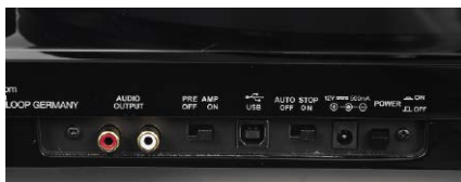
Panel przyłączeniowy wygląda imponująco, są tutaj również przełączniki trybów pracy przedwzmacniacza i systemu automatyki.
