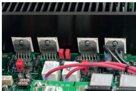
Końcówki mocy to kompletne układy scalone (po dwa na kanał).
