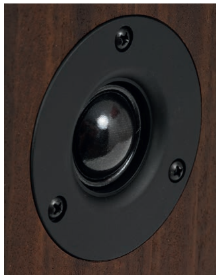
Głośnik wysokotonowy znany już z poprzednich „Speaker Boxów” – to 25-mm kopułka tekstylna, z krótką tubką.
