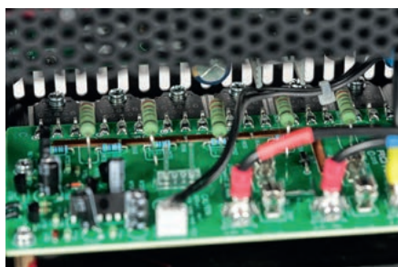
Końcówki mocy oparto na baterii tranzystorów Sanken, w każdym kanale pracuje aż sześć par!
