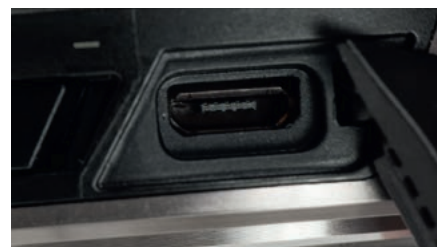
Złącze USB pozwala nie tylko ładować akumulatory, ale również przesłać cyfrowy sygnał PCM 24/96; nie ma tu wejścia analogowego.
