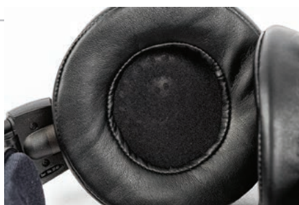
Przetworniki są wyjątkowo duże (53 mm), przed metalowymi dyfuzorami rozciągnięto miękką tkaninę.
