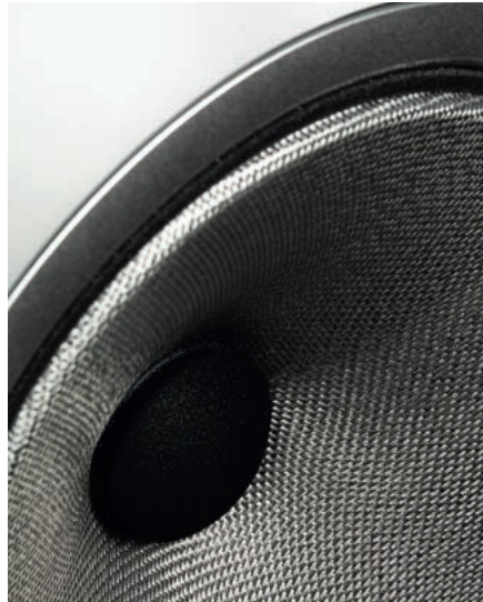
Zamiast Kevlaru plecionka Continuum o zasadniczo podobnych właściwościach, zapobiegających powstawaniu w membranie fal stojących. Zawieszenie typu FST (niemal niewidoczny, cieniutki pierścień z gąbki) jest optymalne dla takiej membrany, o ile stosowana jest ona tylko w zakresie średniotonowym.
