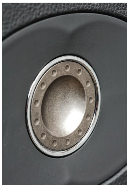
Wklęsła kopułka wysokotonowa, a wokół niej jeszcze dodatkowa, delikatna, ale obszerna wklęsłość – tworząca profil wpływający na charakterystyki kierunkowe.
