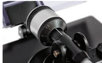
Przeciwwaga z czytelną skalą, nacisk dla fabrycznej wkładki powinniśmy ustalić na 3,5 G.
