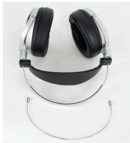
Obok głównego, metalowego pałąka zainstalowano także dodatkowy drążek, pełniący rolę sprężyny dociskającej muszle do głowy. Drążek można zastąpić innym lub w ogóle go zdjąć.
