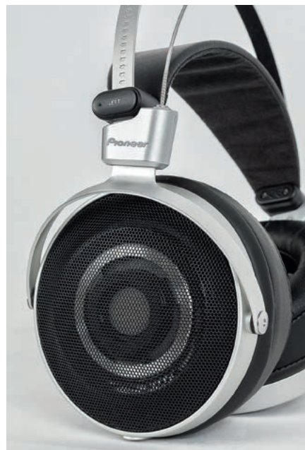
SE-Master 1 to konstrukcja otwarta; duże, 50-mm przetworniki możemy obejrzeć od tyłu przez ażurową obudowę muszli.
