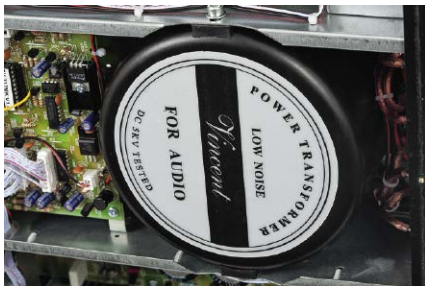
Jeden duży transformator toroidalny zasila wszystkie układy i świetnie sobie z tym radzi.
