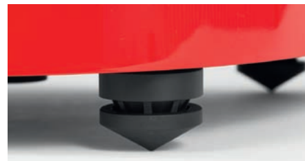
W podstawę wkręcono trzy nóżki (każda z regulacją) o „sandwiczowej” konstrukcji z metalowym stożkiem, tuleją górną i łączącym je elastomerem (tłumiącym drgania).
