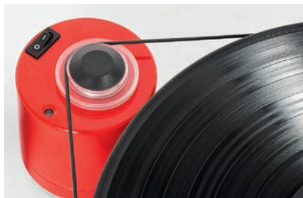
Silnik ustawiamy obok gramofonu, można to zrobić niemal dowolnie – z boku, z tyłu lub z przodu – oby tylko przestrzegać właściwej odległości między trzpieniem rolki napędowej a osią talerza.
