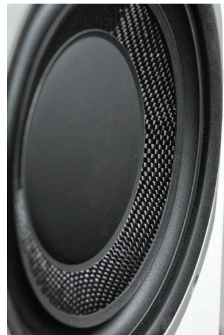
Membrany niskotonowe są wielowarstwowe – z przodu widać plecionkę z włókna szklanego, która jest sklejana z warstwą celulozy i dodatkowo usztywniona dużą nakładką. Zawieszenie jest „odwrócone”, jednak przygotowane do dużych wychyleń.
