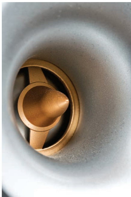
Wysokotonowy Triangle to prawdziwa tuba, a nie tylko kopolka doposażona w krótki tubowy profil. Za tubą mamy komorę sprzęgającą i korektor fazy, a membrana jest tytanowa.
