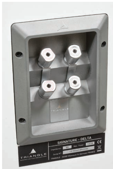
Podwójne gniazdo w „puszce”, lecz nie zwykłej, plastikowej – w aluminiowym odlewie.
