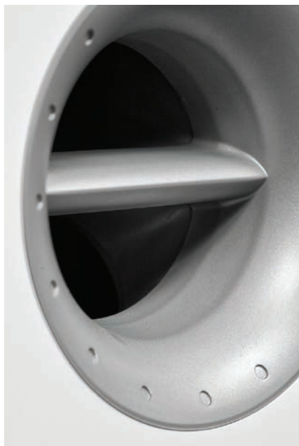
Wylot bas-refleksu wygląda ciekawie, bo kryje się za nim nietypowy układ tuneli – jeden biegnie w dół, do komory dolnego głośnika niskotonowego, drugi – do komory górnego.
