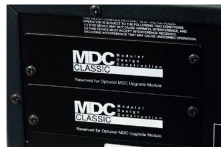
C388 ma dwie tzw. zatoki dla modułów MDC, dzięki którym można dodać kolejne funkcje, np. odtwarzacz strumieniowy.
