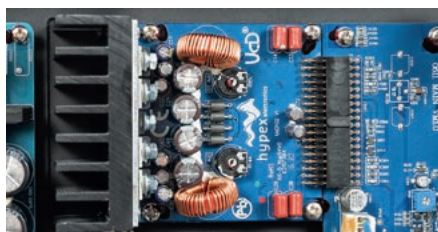
Końcówki mocy przygotowano we współpracy z firmą Hypex, specjalizującą się w klasie D.
