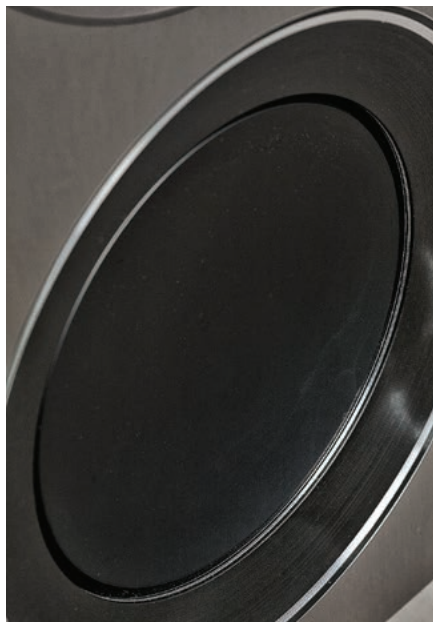
Membrana niskotonowa ma kształt wycinka sfery (konkawa), z tyłu prowadzi ją element w formie koszyka, będący przedłużeniem dużej cewki drgającej. Zawieszenie jest odwrócone i schowane pod zewnętrznym pierścieniem, pozwala na pracę z dużymi wychyleniami i nie zakłóca promieniowania, pozwalając utrzymać gładką powierzchnię wokół membrany.
