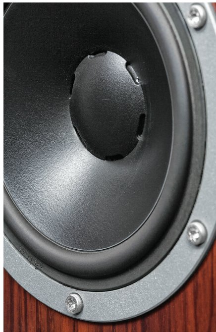
15-cm głośnik średniotonowy ma, jak na Dynaudio, umiarkowaną, ale w skali bezwzględnej wcale nie bardzo małą cewkę – o średnicy 38 mm.
