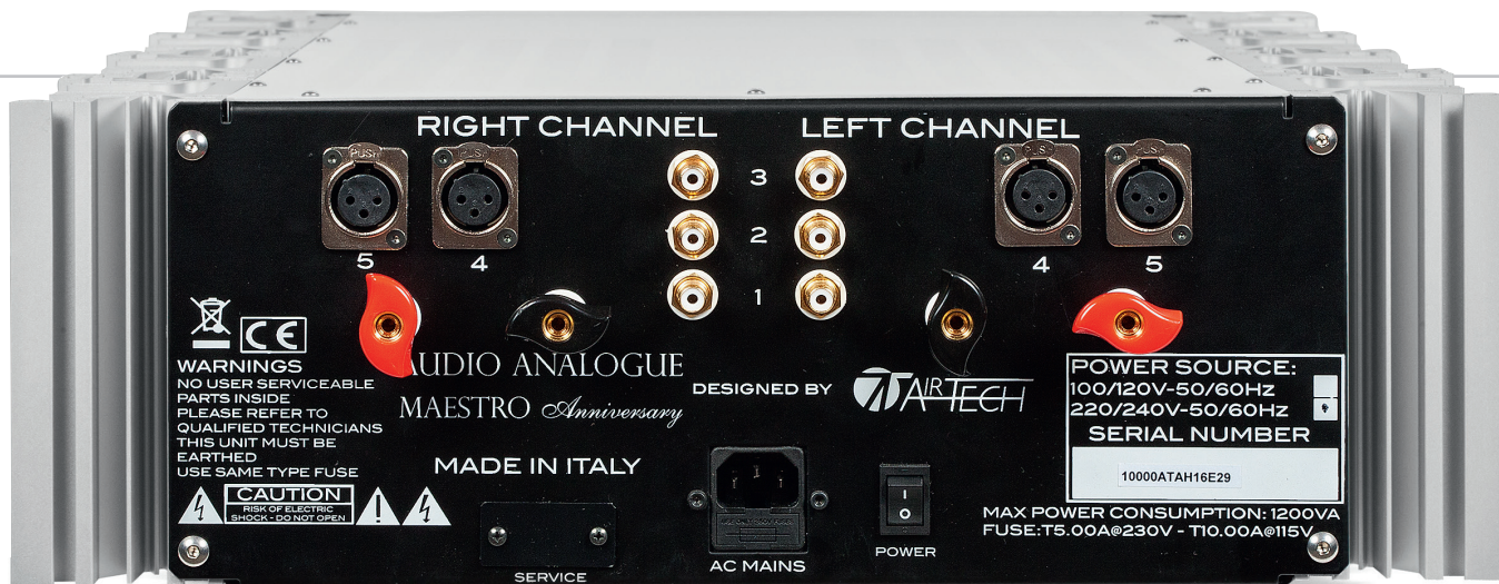
Maestro Anniversary jest klasycznym wzmacniaczem analogowym, bez wejść cyfrowych i wbudowanego przetwornika DAC.
