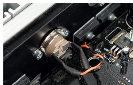
Jednym z ogniw obszernego układu zabezpieczeń są czujniki termiczne, niezależne dla obydwu kanałów.
