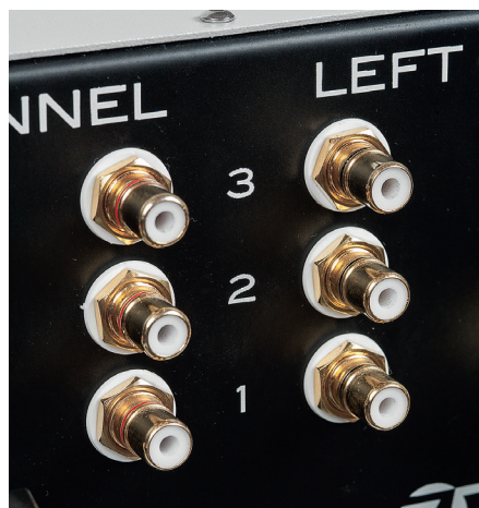
Trzy pary RCA przyjmują sygnały liniowe, nie ma jednak wejścia dla gramofonu ani żadnych wyjść z sygnałem niskopoziomowym.
