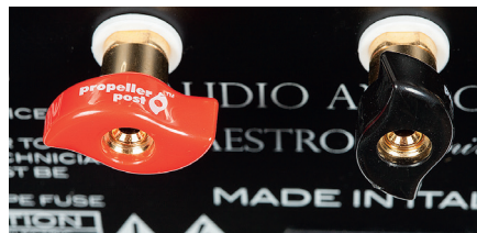
Terminaly z nakrętkami motylkowymi obsługują największe końcówki widelkowe, instalacja kabli jest szybka, nie wymaga użycia dużej siły.
