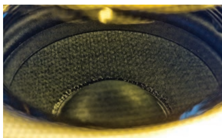
9-cm głośnik nisko-średniotonowy schowano w zagłębieniu stożkowej obudowy.
