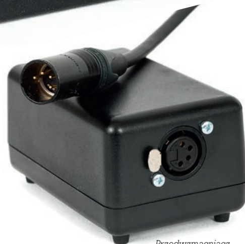
Przedwzmacniacz ma zewnętrzny zasilacz, podłączony grubym, ekranowanym kablem z końcówką XLR4.
