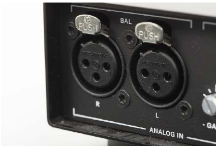
Cały tor sygnału jest zbalansowany – w niewielkim wzmacniaczu słuchawkowym to mniejsze wyzwanie niż we wzmacniaczu zintegrowanym.
