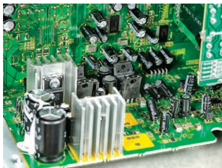
Rozbudowany układ przedwzmacniacza gramofonowego ulokowano na niezależnej płycie.
