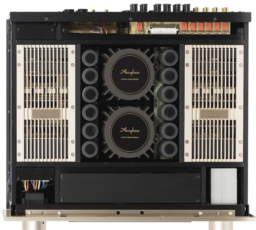
C-3900 to piękny układ dual-mono, a bogactwem i zagęszczeniem układów, także potencjałem zasilacza, przypomina bardziej wzmacniacz niż przedwzmacniacz.
