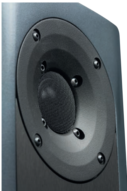
Głośnik wysokotonowy to 25-mm metalowa kopułka, chroniona metalową siatką; wyprofilowany („krótka tubka”) front jest coraz częściej stosowany w konstrukcjach zarówno studyjnych, jak i domowych, pozwala dopieścić charakterystyki kierunkowe, które przecież w koncepcji Kii Three są bardzo kluczowe.
