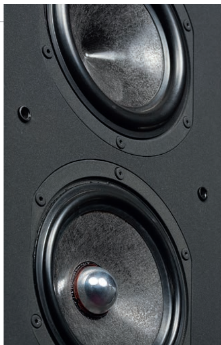
Para głośników średnionotonowych pracuje w różnych podzakresach; głośnik „dolnego środka” (w układzie „odwrotnym” znajduje się wyżej) ma membranę typu „full-apex”, głośnik pracujący w szerszym podzakresie (aż do podziału z wysokotonowym) ma korektor fazy, prawdopodobnie poprawiający charakterystykę w zakresie „wyższego środka”.
