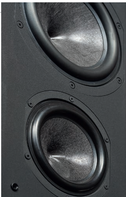
17-cm głośnik niskotonowy (na górze) i 13-cm głośnik „dolnego środka” mają podobne profile i materiały membran, wykonanych z pianki Rohacell. „Stożek” (a dokładnie – powierzchnia o profilu wykładniczym) biegnie aż do samego wierzchołka, cewka drgająca jest mocowana w „dowolnym” miejscu. Co jednak ciekawe, taki profil nie został uznany za absolutnie uniwersalny..
