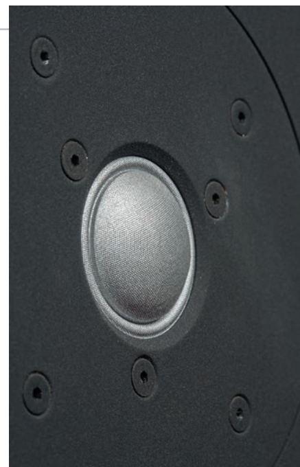
Kopułka wysokotonowa jest nietypowa co najmniej z dwóch powodów – po pierwsze, jej materiał to połączenie tekstylnej „bazy” i warstwy aluminiowej; po drugie, jej 32-mm średnica pozwala na uzyskanie większej wytrzymałości, a przez to – ustalenie łagodnego filtrowania i niskiej częstotliwości podziału (poniżej 2 kHz).
