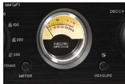
Wskaźnik wychyłowy pokaże poziom sygnałów subsonicznych oraz impedancję podłączonej wkładki!
