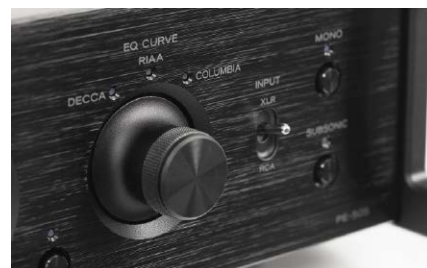
PE-505 pozwala na wybór jednej z trzech krzywych korekcyjnych, jest też filtr subsoniczny oraz przełącznik trybu monofonicznego.
