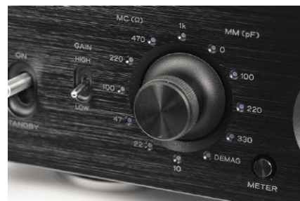
Wielofunkcyjnym pokrętkiem ustawiamy obciążenie (impedancja i pojemność), a system automatycznie dopasowuje poziom wzmocnienia.
