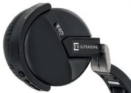
Adapter Sirius zawiera moduł Bluetooth, wzmacniacz słuchawkowy oraz akumulator ma postać niewielkiego rogała o masie zaledwie 12 g.
