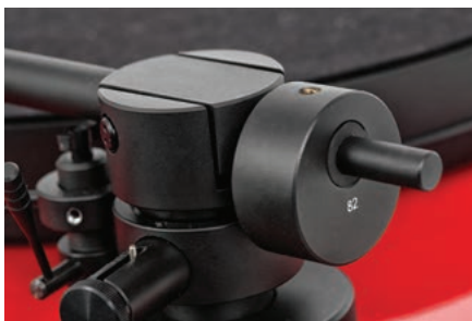
Przeciwwagę zainstalowano mimośrodowo, blokując śrubą imbusową, w środku znajduje się elastyczny tłumik drgań. Nie ma wprawdzie skali, ale w komplecie dostajemy prostą wagę.
