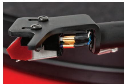
Główkę połączono z rurką ramienia, przewody sygnałowe oraz masowy są prowadzone wewnątrz.
