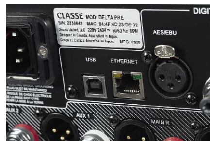
W sekcji cyfrowej błyszczą jak zwykle wejście USB-DAC, które przyjmie tutaj sygnały PCM 32/384 oraz DSD256.
